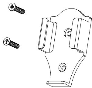
用2颗螺丝把遥控座固定在墙壁上
